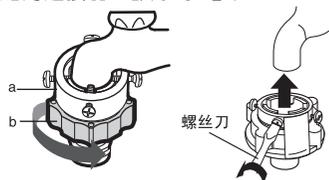
3. 连接器套上水龙头向上与水龙头靠紧后，用螺丝锁紧，再转螺母b部分使ab合并。
