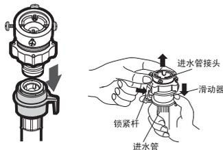
2. 首先使用十字起子松开四个螺丝，然后把螺母b部分按箭头方向转，转至距离连接器a部分约5毫米。
