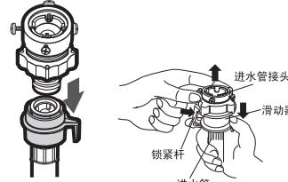
2. 首先使用十字起子松开四个螺丝，然后把螺母b部分按箭头方向转，转至距离连接器a部分约5毫米。
