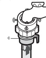
5. 以顺时针方向将进水管的另一端拧紧在洗衣机进水口上。
