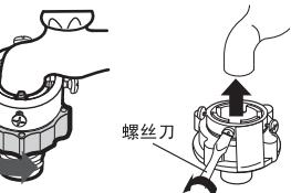
3. 连接器套上水龙头向上与水龙头靠紧后，用螺丝锁紧，再转螺母b部分使ab合并。
